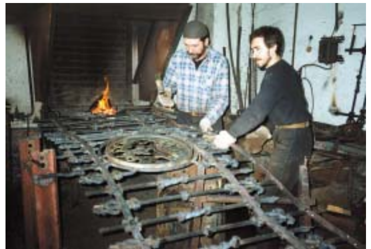
Кузнецы из Ярославля за изготовлением ограждения балкона для Музея Н.К.Рериха. 1999
